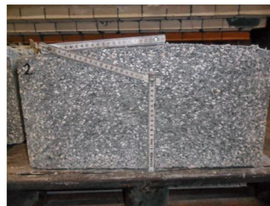
Schnittbild durch das Betongefüge von JuFAST HP000Q nach dem Aufheizen mit einer linearen Temperatursteigerung von 100 K/h. Ergebnis: keine erkennbaren Risse im Gefüge.
