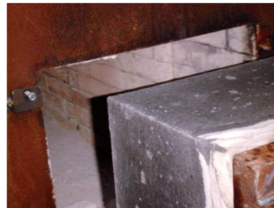
Einsetzen des Betonblocks, Abmessungen 500 x 500 x 250 mm in den Versuchsofen.
