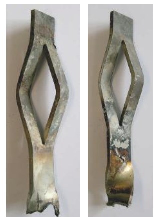
JuSys® ACL -Anker nach ca. 24.000 Betriebsstunden
