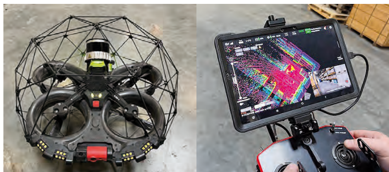
Abb. 6: Überlagerung von Punktwolkenmenge/Realbildern bei der neuen JuSpect® 3D-Inspektionsdrohne in unserem Lager
