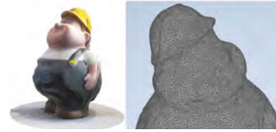
Abb. 5: Polycam®-SCAN und 3D -Netzkörper von „Herrn Bert J+G“
