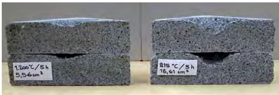
Bild 8: Test der Abriebsbeständigkeit eines freifließenden SiC-Feuerbetons bei unterschiedlichen Brenntemperaturen
