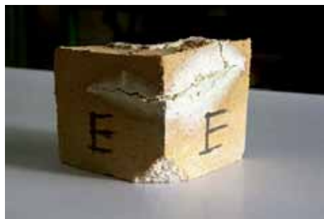
Bild 10: Alkalitest an Steinen ohne Insitu-Infiltrationsschutz (JuRA 4 -Technologie)
