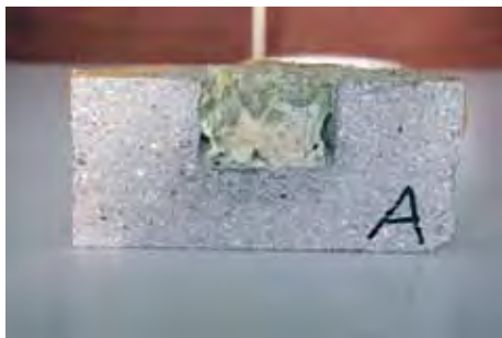
Bild 9: Alkalitest an Steinen mit Insitu-Infiltrationsschutz (JuRA 4 -Technologie)
