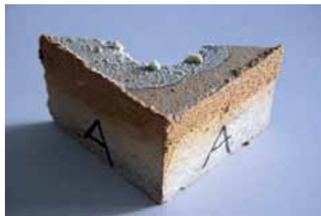
Bild 9: Alkalitest an Steinen mit Insitu-Infiltrationsschutz (JuRA 4 -Technologie)
