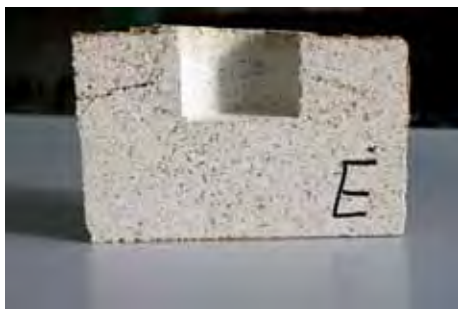
Bild 10: Alkalitest an Steinen ohne Insitu-Infiltrationsschutz (JuRA 4 -Technologie)
